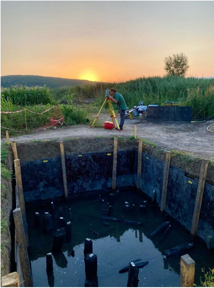
Abb. 2. Jeden Morgen wird die Totalstation anhand festgelegter Punkte, die mit Hilfe des dGPS bestimmt wurden, neu ausgerichtet. Foto: Universität Bern, EXPLO-Projekt, Martin Hinz.
