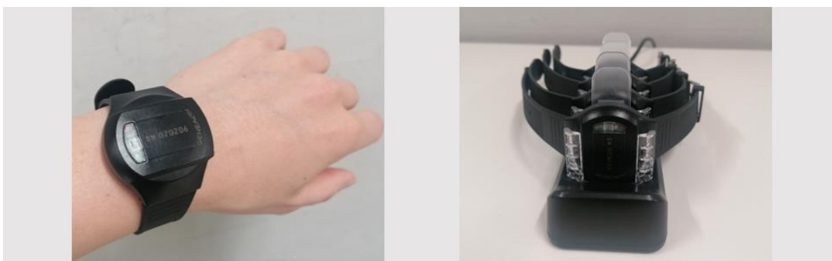
Abbildung 1: GENEActiv-Uhr und Ladestation. Die Uhren werden jeweils aufgeladen und mittels GENEActiv-Software initialisiert (z.B. 7 Tage Tragedauer). Nach dem Trageintervall werden die Rohdaten über die Software heruntergeladen und anschliessend mittels R-Package GGIR weiterverarbeitet.
