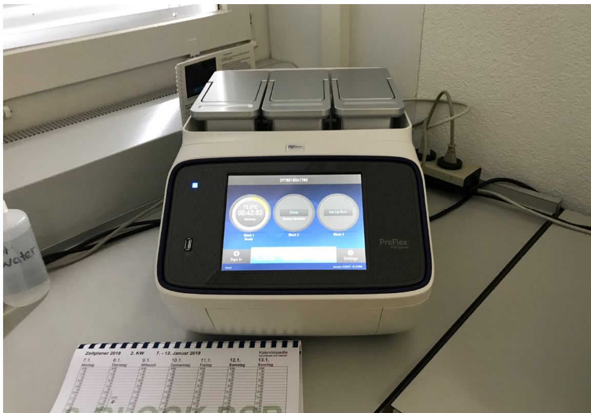
Abbildung 3: Der durch die UniBern Forschungsstiftung mitfinanzierte Thermocycler ermöglicht die Herstellung von «Sequencing Libraries» als Ausgangsmaterial für die RNA-Sequenzierung. (Foto: M. Dettwiler, Universität Bern)
