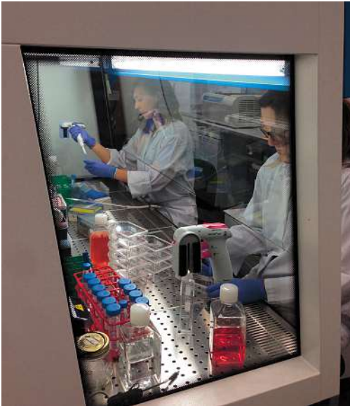
Bild 1: Die durch die UniBern Forschungsstiftung mitfinanzierte Sicherheitswerkbank erlaubt das Arbeiten mit Zellkulturen unter sterilen Bedingungen. Photo: T. Kaufmann, Bern.
