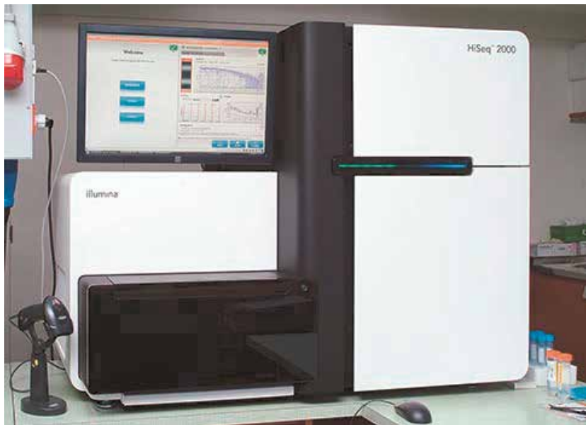
Abb. 2: Hochdurchsatz-Sequenzierungsgerät der Next Generation Sequencing Plattform . Mit diesem Gerät können bis zu 16 Genome von Säugetieren gleichzeitig in einem einzigen Experiment sequenziert werden. Ein derartiges Experiment dauert etwa zwei Wochen und liefert 600 Gb Daten, was eine extrem leistungsfähige Computer-Infrastruktur erfordert.
